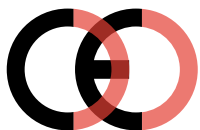
Virheellinen CE-merkki (liian lähellä)
